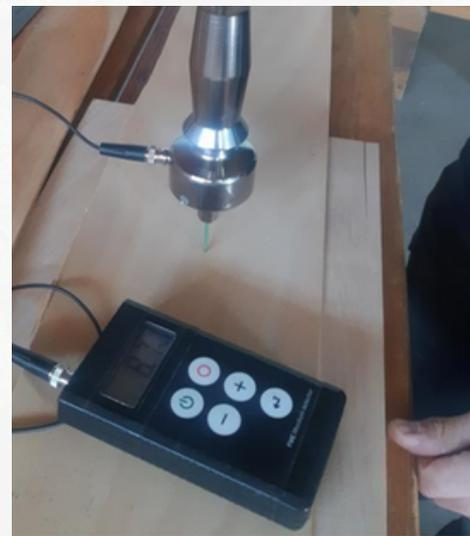
Figura 6. Control de humedad de chapas con xilohigrómetro
