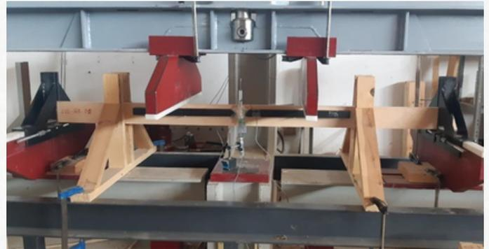
Figura 11. Ensayo a flexión en probetas de tamaño
