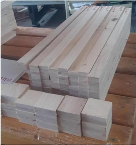
Figura 10. Probetas de pequeñas dimensiones para ensayos a flexión (superiores) y para ensayos a tracción perpendicular a la fibra (inferiores).
