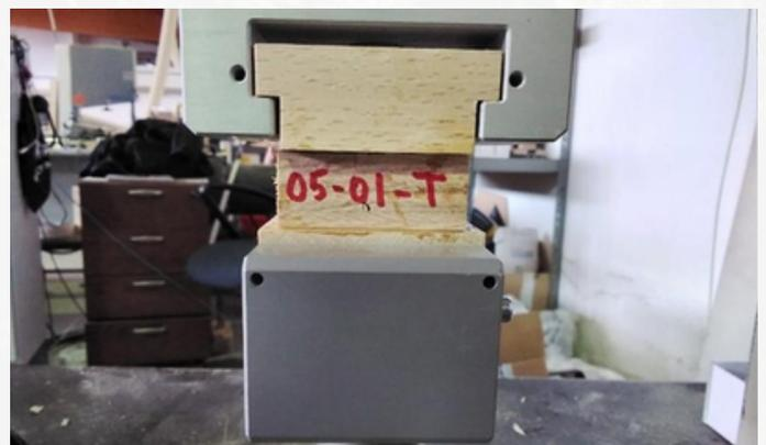
Figura 13. Ensayo a tracción perpendicular en la fibra
