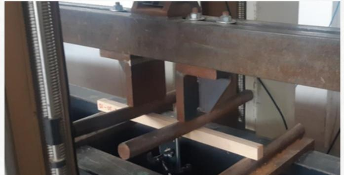
Figura 12. Ensayo a flexión en probetas de pequeñas dimensiones
