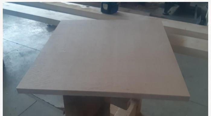
Figura 9. Panel de 500x500 mm, utilizado para elaborar probetas de pequeñas dimensiones
