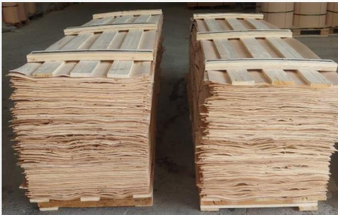
Figura 1. Chapas de haya utilizadas para la fabricación del LVL
