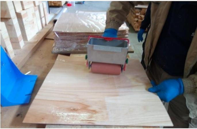
Figura 7. Encolado y colocación de chapas
