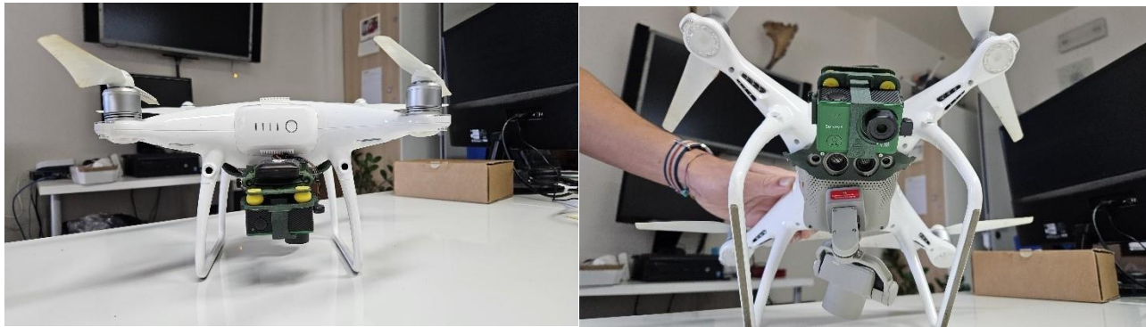
Figura 5 - DJI Phantom 3 equipaggiato con MAPIR Survey 3 che acquisisce nelle bande Rosso, Verde, Infrarosso
