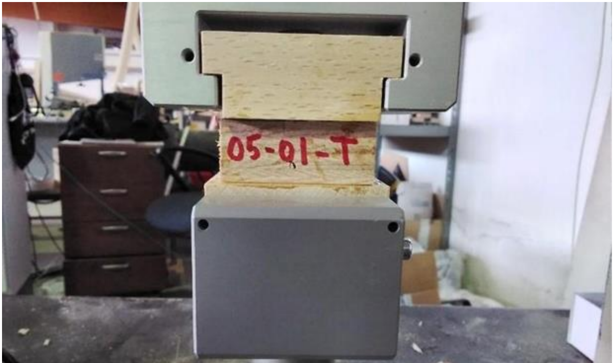
Ensayo a tracción perpendicular a la fibra
