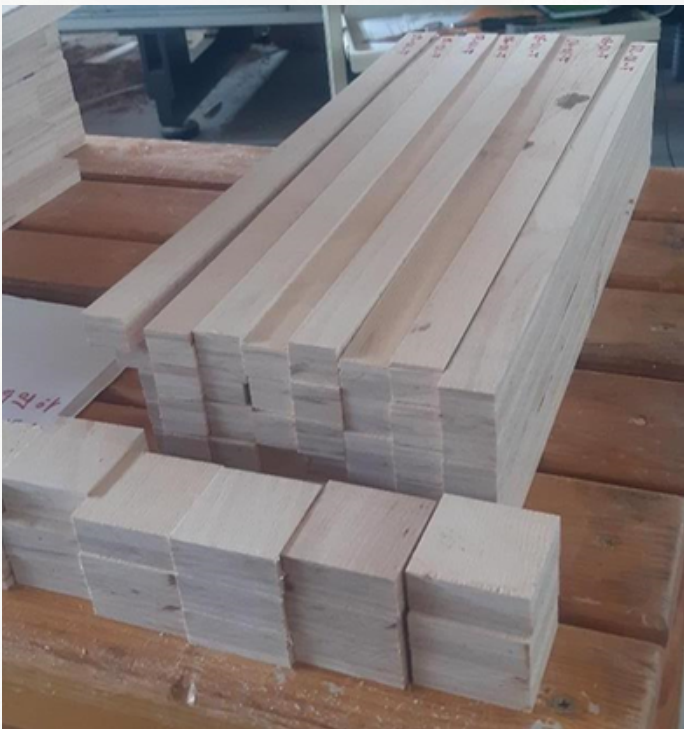
Kuva 10. Pienet näytteet taivutuslujuuskokeita (ylempi osa kuvassa) ja kohtisuorassa syitä vastaan tehtäviä vetolujuuskokeita varten (alempi osa kuvassa).
