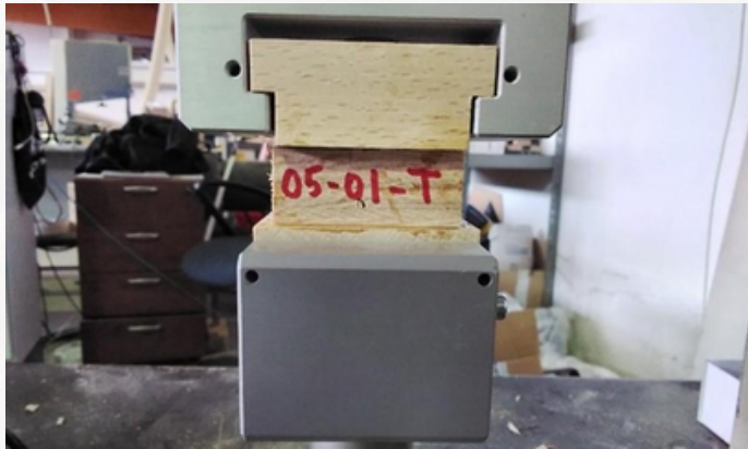
Kuva 13. Vetolujuustesti kohtisuoraan syitä vastaan.
