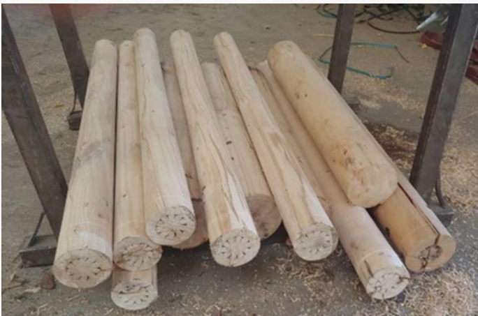
Kuva 5. Sorvauksesta jäljelle jääneet puiden keskusosat.
