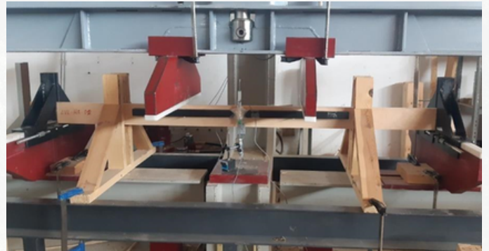
Kuva 11. Taivutuslujuustesti rakenteellisesti mitoitetuille näytteille.
