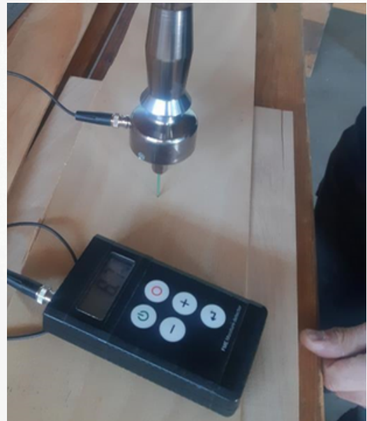
Kuva 6. Viilujen kosteuden seuraamista kosteusmittarilla.
