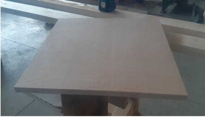
Kuva 9. Pienten näytteiden valmistuksessa käytetty 500x500 mm paneeli.
