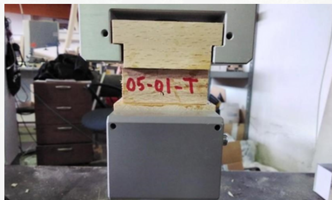
Slika 13: Natezni preizkus pravokotno na vlakna.
