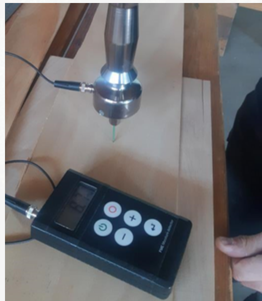
Slika 6: Meritev vlažnosti furnirja z vlagometrom.
