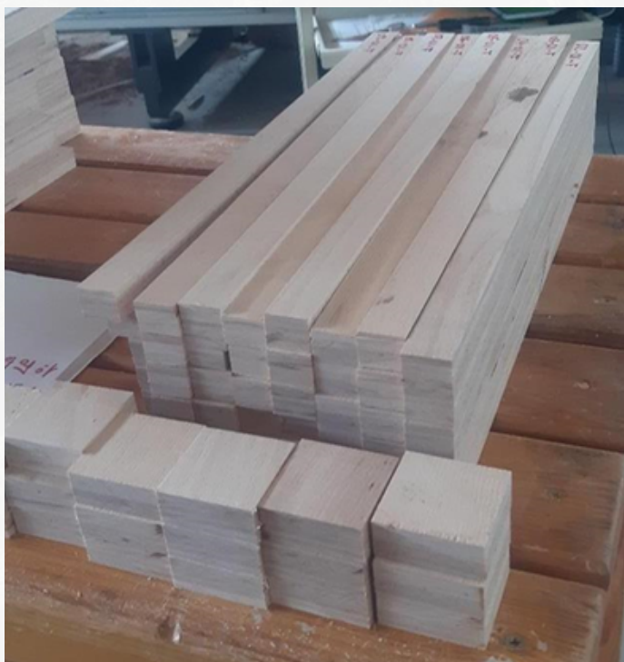
Slika 10: Vzorci letev za upogibne preizkuse (zgornji) in za natezne preizkuse (spodaj).
