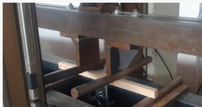
Slika 12: Upogibni preizkus na letvah.
