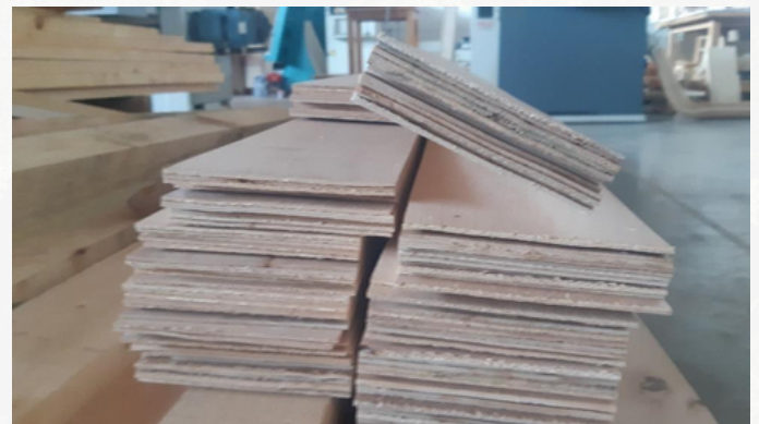
Slika 8: LVL deske dimenzij 125 x 30 x 2500.
