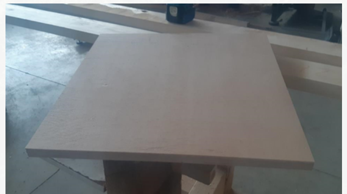
Slika 9: LVL plošča dimenzij 500 x 500 mm, uporabljena za izdelavo vzorcev manjših dimenzij.
