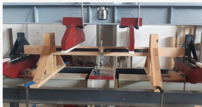
Slika 11: Upogibni preizkus na deskah.
